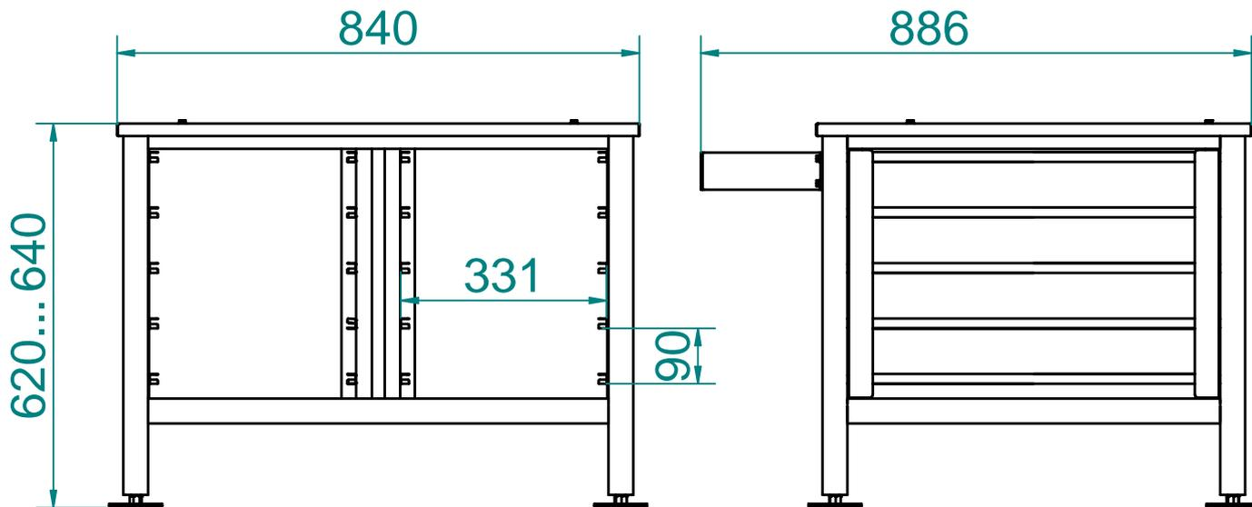
Подставка ПК-10МФ является вспомогательным оборудованием и предназначена для установки пароконвектомата типа ПКА10-1/1ПМФ2 на столешницу и размещения 10 gastronormов GN 1/1 на держателях полок.
